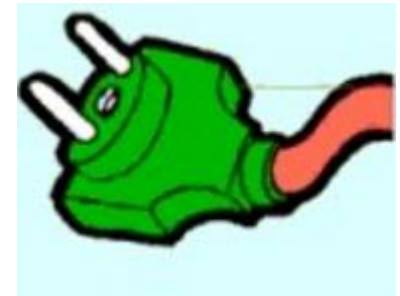
Falta de conexión a tierra
